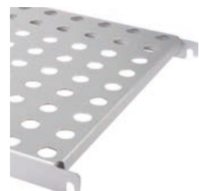
Lochboden 1.5 mm stark Ø 24 mm Teilung 50 mm
