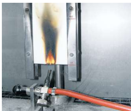
Qualitätsprüfungen über den gesamten Fertigungsfluss: Brandprüfung
