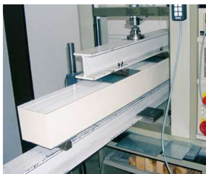
Computergestützte Qualitätsprüfungen: Biegeprüfung
