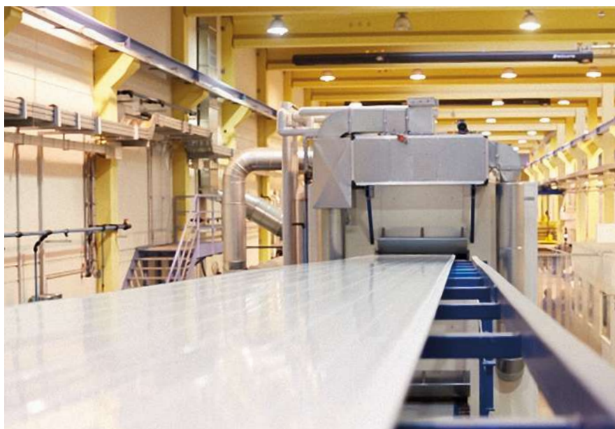
Kontinuierliche Sandwichfertigung mit den modernsten und größten Doppelbandanlagen der Welt
